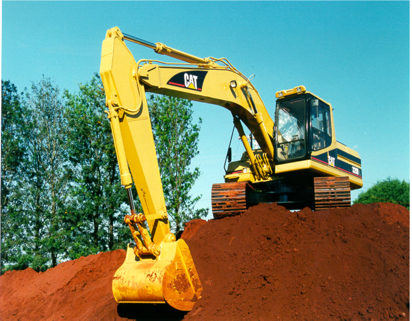
Escavadeira Hidráulica 320B
